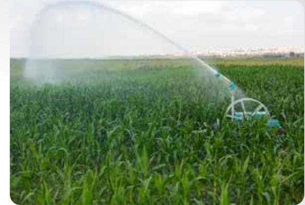
Irriforce es una máquina de riego que está diseñada para ofrecer Eficiencia Energética. Tanto el uso y el coste de inversión es mucho más bajo que sus competidores. Podemos decir que Irriforce es una pistola de riego autopropulsada. Gracias a la turbina de agua y la cuerda de acero, la máquina realiza el riego de manera autopropulsada.
